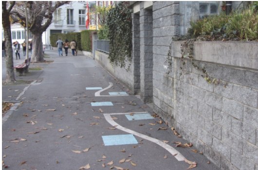
Sinnvolle Markierung zur Verdeutlichung eines möglichen Konfliktpunktes
